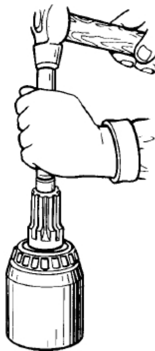
Abb. 6 Ausbau des hinteren Lagerbocks des Antriebszahnrad
